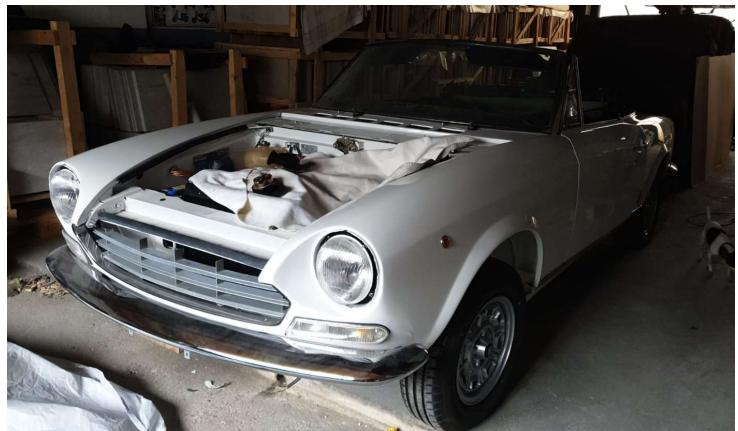
Sulla via di ritorno ero contentissimo, della seduta bassa e del rombo di quel 4 cilindri. Subito diede la notizia iniziò il restauro, il nostro esperto di motori (Lino) era da subito entusiasta ed iniziò a ricostruire quel fantastico motore, sono stati allargati i cilindri e la testata è stata spianata, il motore è stato rifatto completamente.
